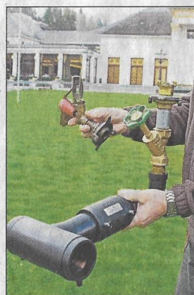
So sieht die neue Gießwasserleitung (schwarz) mit Entnahmestelle aus.
